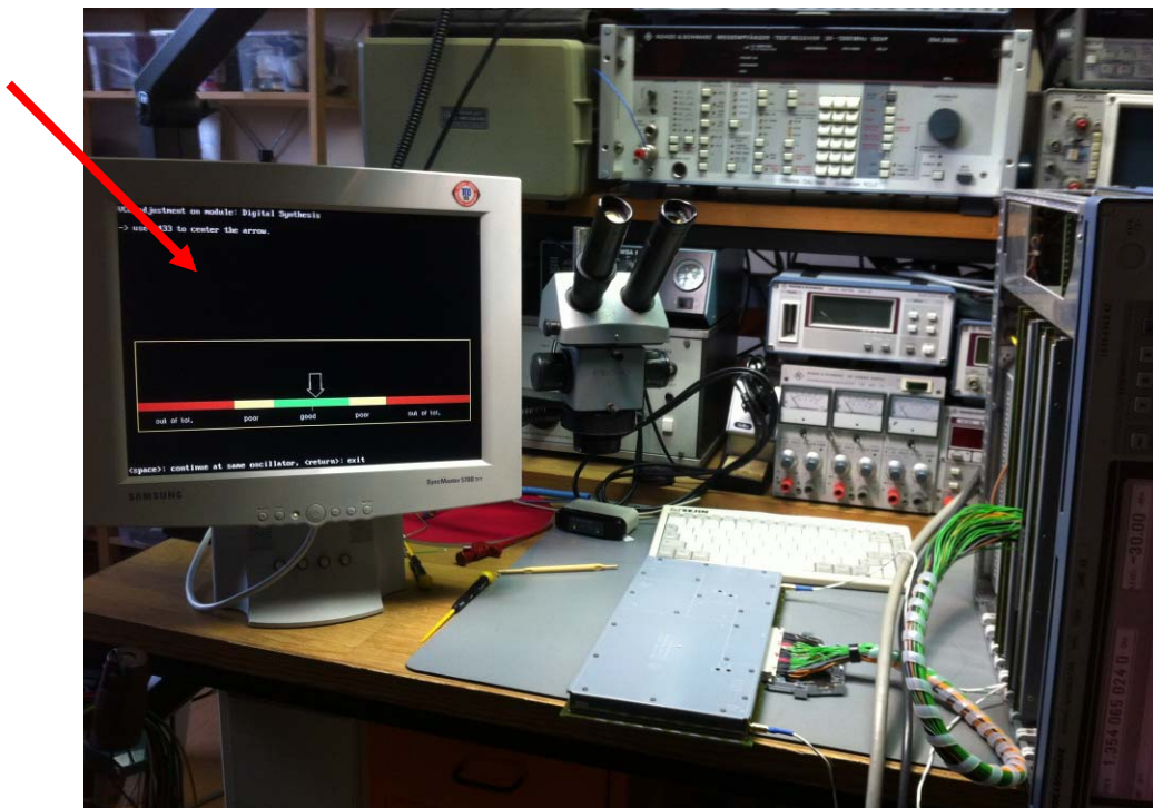
Abbildung 25: Abgleich einer Baugruppe mit dem Service-Kit SK-Z3
