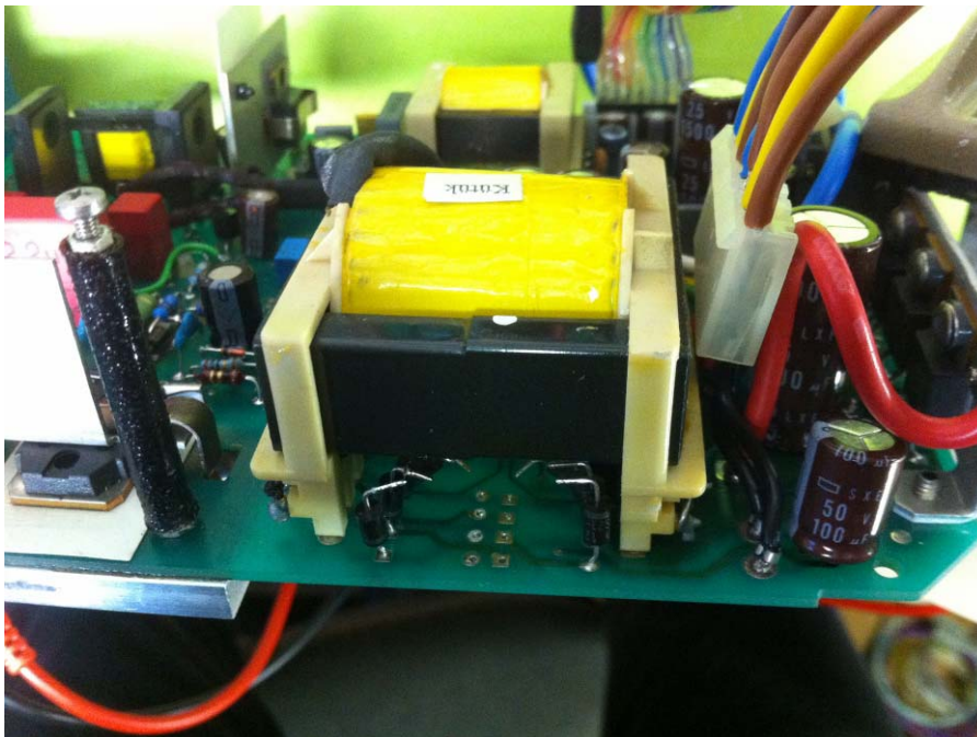
Abbildung 20: Gleichrichterdiode zum Messen hochgelötet
