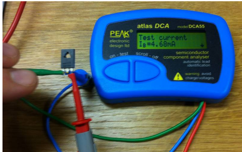
Abbildung 15: praktischer Helfer: Halbleiter-Prüfgerät von PEAK (hier beim Test eines BD139)
